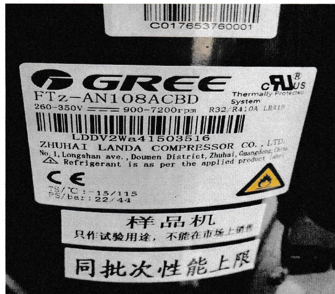
Photo de la plaque signalétique du compresseur
