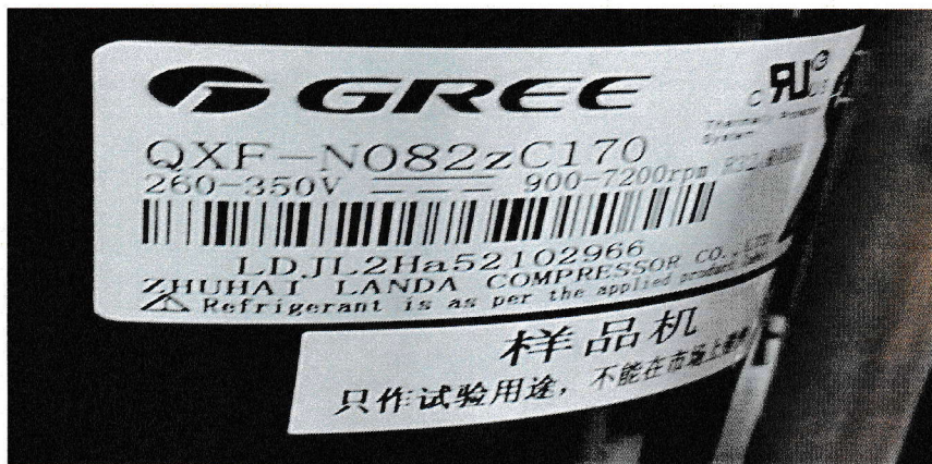
Photo de la plaque signalétique du compresseur
