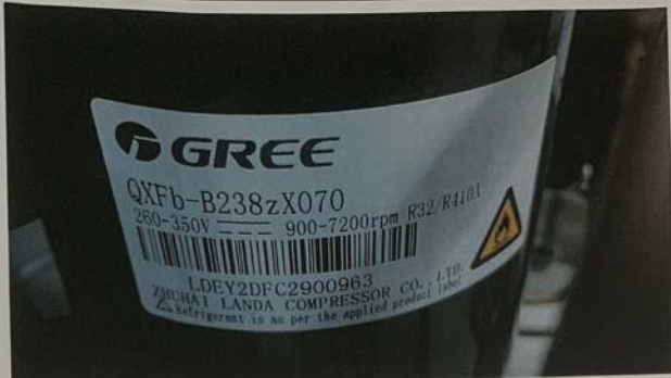
Photo de la plaque signalétique du compresseur
