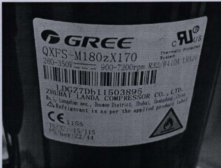
Photo de la plaque signalétique du compresseur
